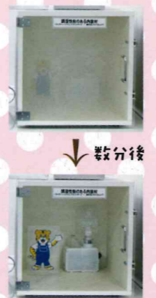
加湿器による湿気で曇った容器で実験。「スカットボード」を使用した箱は、数分で曇りが消えました。
